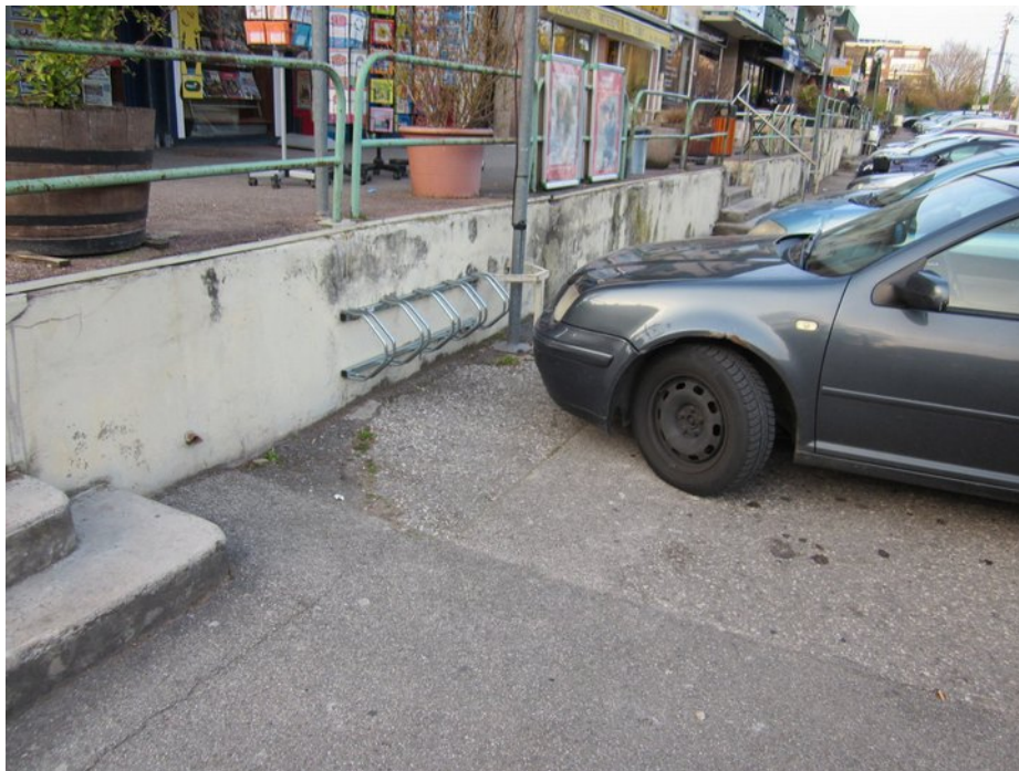
Illustration 3: Au centre du levant, racks vélos complètement inutilisables, qui si ils sont utilisés bloquent les voitures et les piétons.
