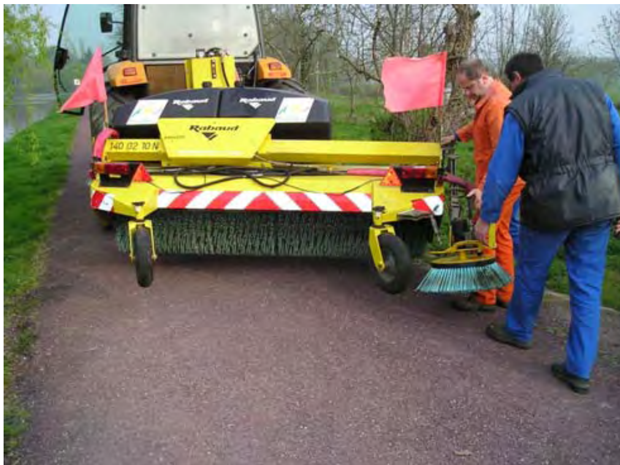
Photo 160 : opération d'entretien (balayage) sur le canal de Nantes à Brest (56)
