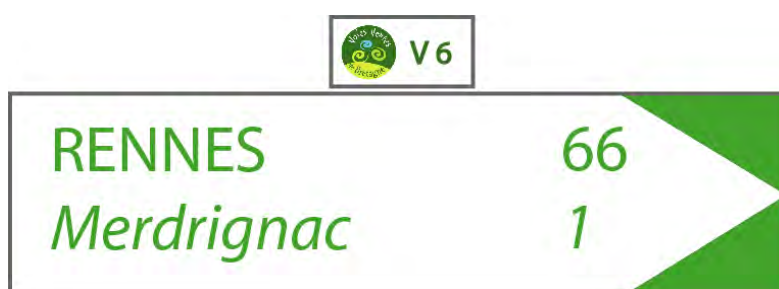
Dv21a (surmonté du cartouche "Voies Vertes de Bretagne") en position en entrée de voie verte
